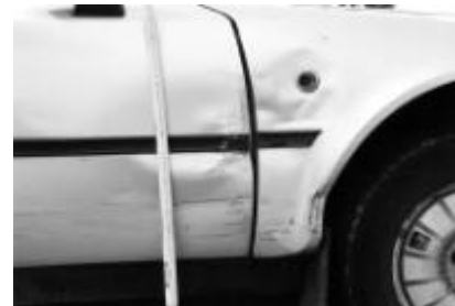
Abb. 1.15: Unfallversuche mit einschwenkenden Pkw. Anstöße vor und hinter der A-Säule des einschwenkenden Fahrzeugs
