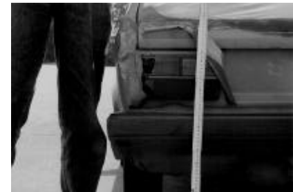
Abb. 1.15: Unfallversuche mit einschwenkenden Pkw. Anstöße vor und hinter der A-Säule des einschwenkenden Fahrzeugs
