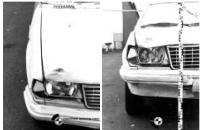
Abb. 1.1.3: Beschädigungen aus Versuch Abb. 1.1.5
